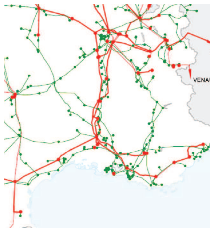
Le réseau 225 et 400 kV de RTE dans le Sud-Est de la France 76
