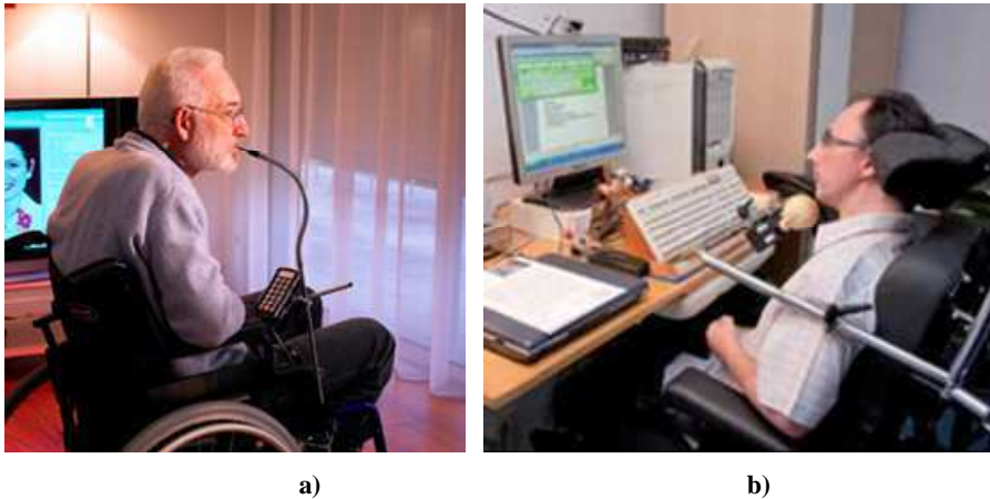
Figure 10.6. Deux exemples de dispositifs d'entrée pour personnes handicapées, a) détecteur de souffle, b) commande oculaire et au menton
