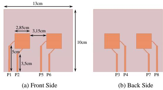
Fig. 6. Reference Antenna.
