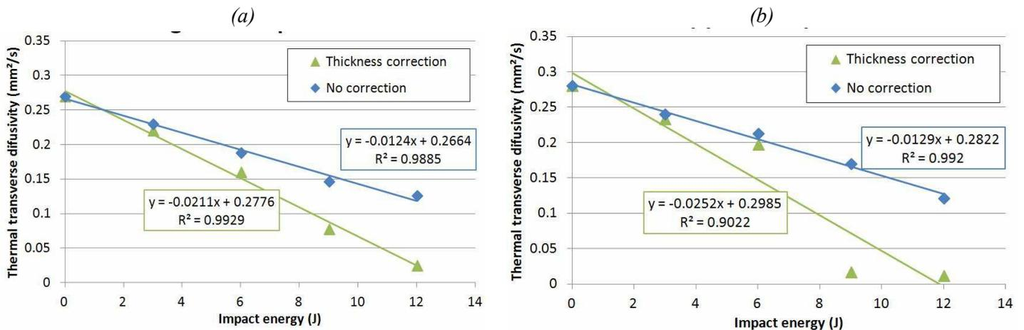
FIG 5 : Mesures de diffusivité thermique après impact en fonction de l'énergie d'impact sur (a) composites "classiques" (b) composites "patchwork". En bleu : courbes brutes utilisant l'épaisseur initiale pour le calcul de la diffusivité ; en vert : utilisation de l'épaisseur vraie après impact.
