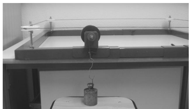
Figure 4 : Photo du dispositif Cordélec (cadre et générateur mécanique)
