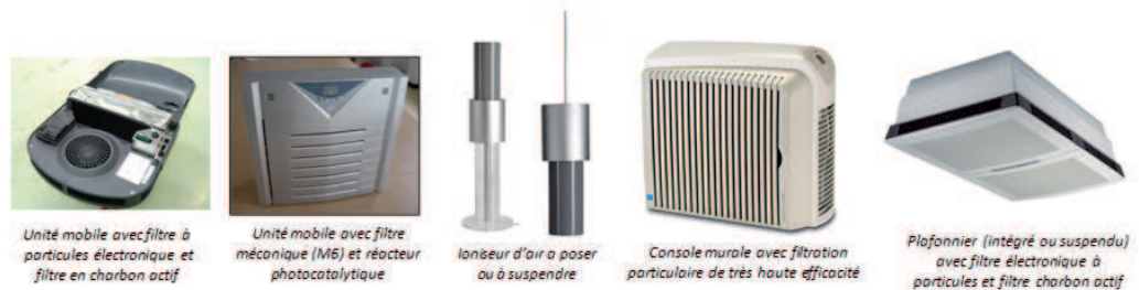
Figure 10 : Épurateurs d'air autonomes fonctionnant par recyclage de l'air intérieur.
