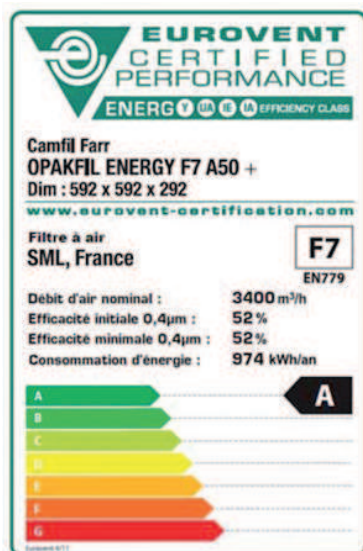
Figure 8 : Exemple d'étiquette énergétique d'un filtre
