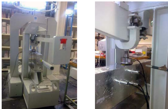
Fig.2 Photographie du banc d'essai : à gauche, zoom sur les transducteurs ; à droite, le bâti de chargement de flexion trois points
