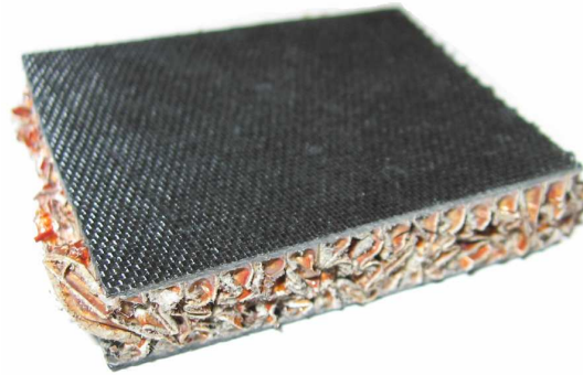
Figure 2 : Ecrasement d'une éprouvette sandwich, peaux carbone/époxy et âme Nomex®
