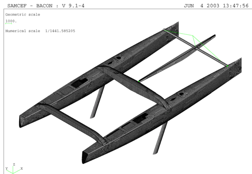
Figure 1. Maillage éléments finis coques du voilier de course Code B1 (Multiplast).
