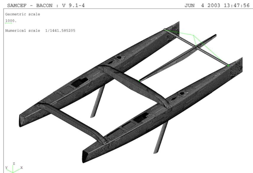
**Figure 1.** Maillage éléments finis coques du voilier de course Code B1 (Multiplast).
