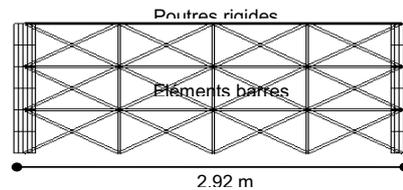
Figure 7 : Maillage béton T12 -  $\alpha = 30.1^\circ$ .
