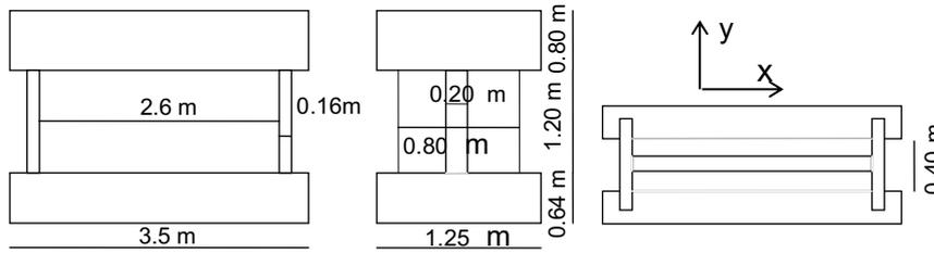
Figure 5: Description des maquettes T5 et T12 .
