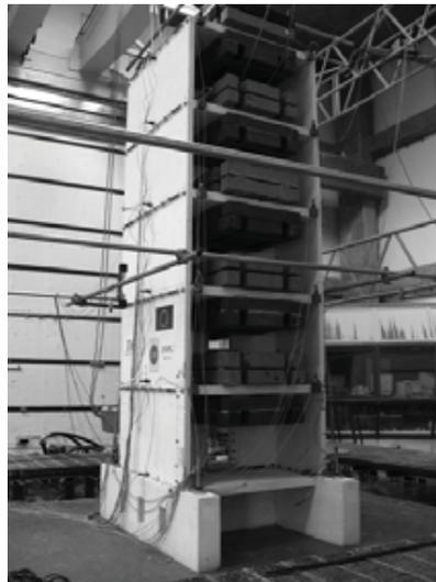
**Figure 8.** *Vue d'ensemble de la maquette et de son instrumentation*
