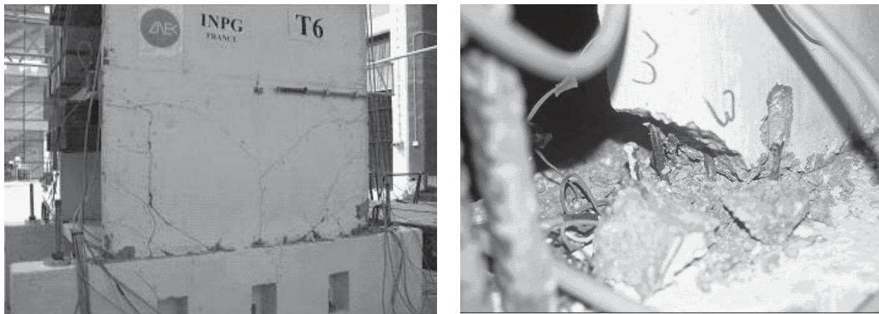
Figure 10. Maquette ECOLEADER. L'état de dégradation (test T6)
