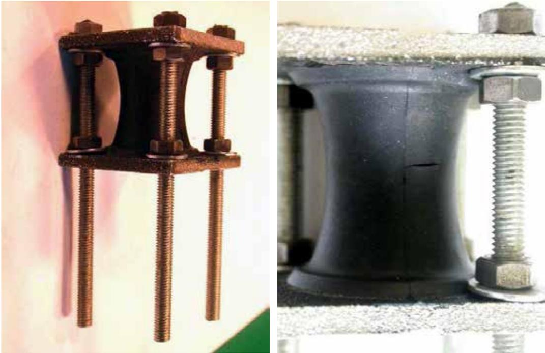
**Figure 3 : montage de mise en tension, la fissure est rendue accessible pour l'observation au MEB**
