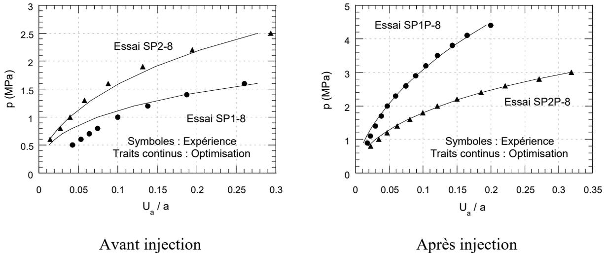
**Figure 10.** *Optimisation sur les essais pressiométriques de Dunkerque*
