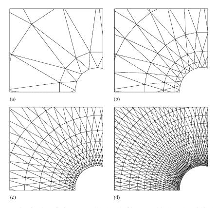
Figure 3. Meshes for the cylinder testcase: (a)  $16 \times 4$ ; (b)  $32 \times 8$ ; (c)  $64 \times 16$ ; and (d)  $128 \times 32$ .
