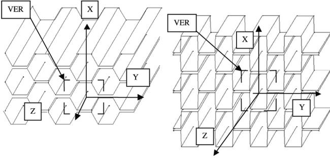
Fig. 2. Cellules de nids d'abeilles hexagonales et sur-expansés.
