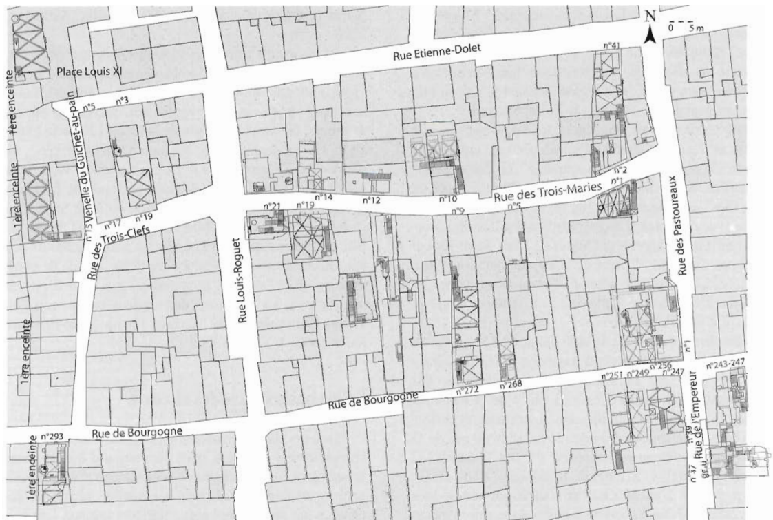
Fig. 3 : Rue des Trois-Maries (plan cadastral de 1823) avec plans des actuels niveaux de caves : niveaux -1 (en noir), parmi lesquels des salles basses; niveaux -2 (en rouge) et niveaux -3 (en bleu), parmi lesquels des anciennes carrières. Quelques salles basses observées dans les rues voisines ont été représentées (C. Alix).
