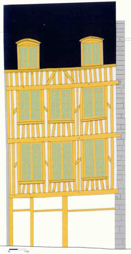
Fig. 5 : maison du 293 rue de Bourgogne : élévation restituée de la façade lors de sa reconstruction, en 1753.
