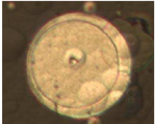
Figure 7 : Diode réalisée sur un pic d'épitaxie.
