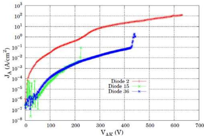
Figure 8 : Tenues en tension à température ambiante.
