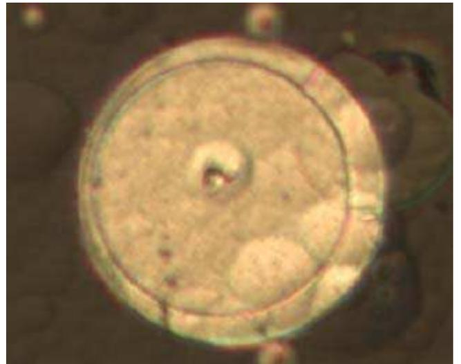
Figure 7 : Diode réalisée sur un pic d'épitaxie.
