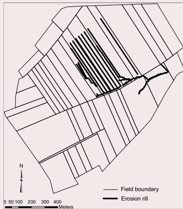
Réseau de rigoles
