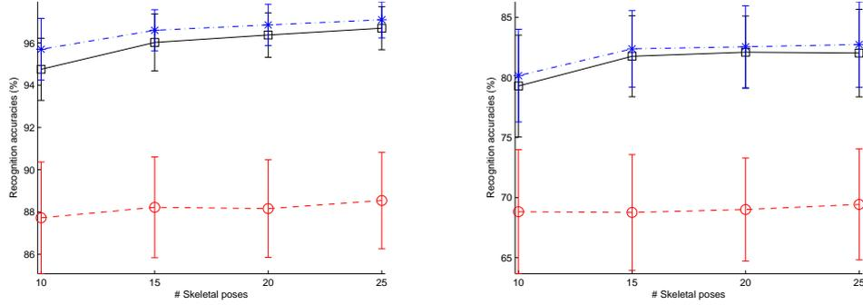
FIG. 2 – Taux de bonne classification obtenus sur la base MSRAAction3D, sur les données d’apprentissage (à gauche) et de test (à droite) pour un nombre de postures par mouvement variant dans  $\{10, 15, 20, 25\}$  :  $K_{ed}$  courbes (rouge, rond, trait),  $K_{dtw}$  courbes (noire, carré, plein),  $K_{dtwr}$  courbes (bleu, étoile, point-trait).
