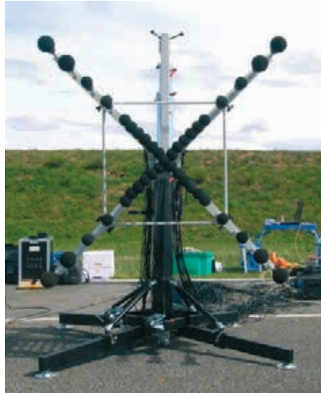
Figure 5 : porte-antenne acoustique pour la localisation des sources
