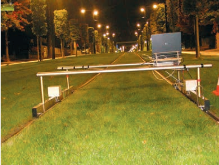
Figure 53 : chariot CATA sur le site de Ferrière
