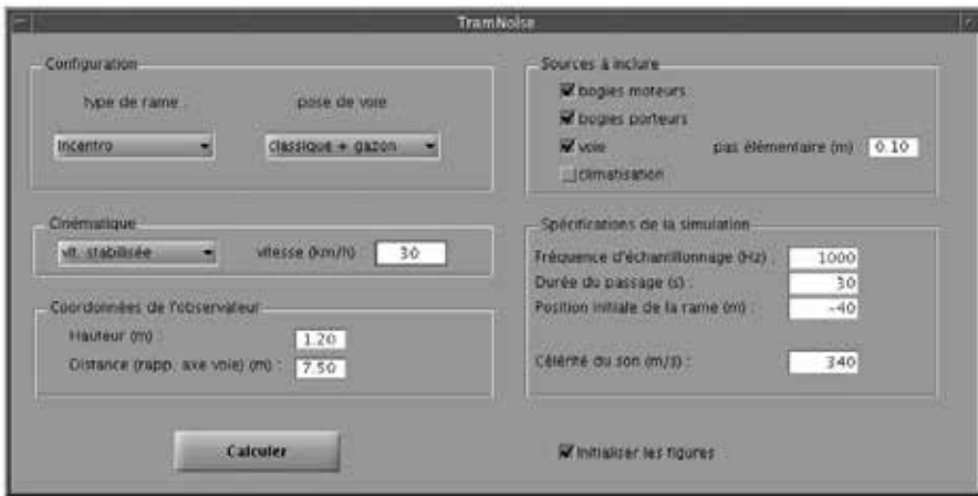
Figure 37 : interface graphique du modèle d'émission du tramway (TramNoise), saisie des paramètres
