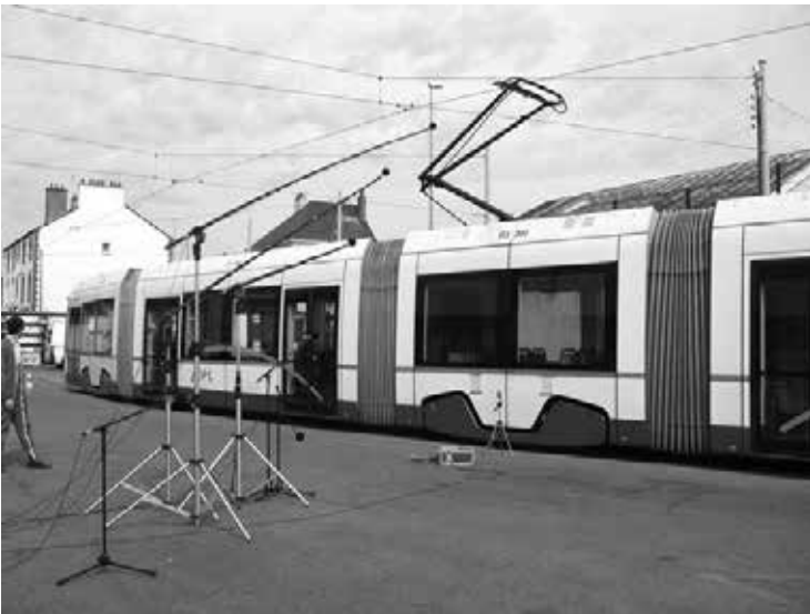
Figure 2 : mesure de la directivité d'une rame de tramway
