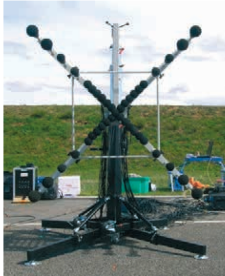
Figure 5 : porte-antenne acoustique pour la localisation des sources
