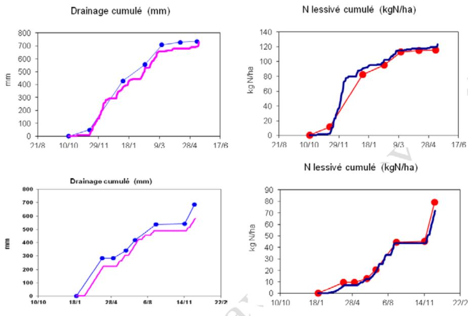
**Figure 4 :** Comparaison entre les résultats de drainage et de lixiviation de l'outil Syst'N (trait sans marque) et les résultats expérimentaux (trait avec les points) ; haut : Crecom (22), essai Chambre Régionale d'Agriculture de Bretagne (CRAB) ; bas : Trévarez (29), essai CRAB, projet Casdar Gestion durable de sols.
