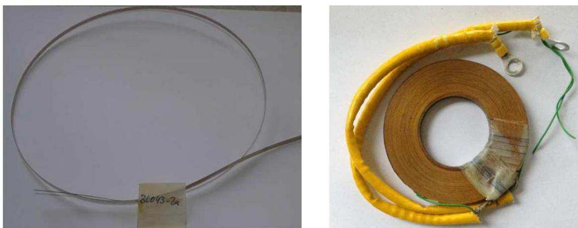
Figure 3 : Échantillon du ruban supraconducteur (BSCCO2212) et image de la bobine supraconductrice utilisée dans l'expérience
