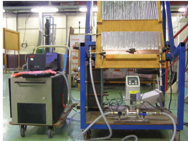
Figure 17 : Schéma du banc caloduc pulsé, et photo du banc caloduc pulsé
