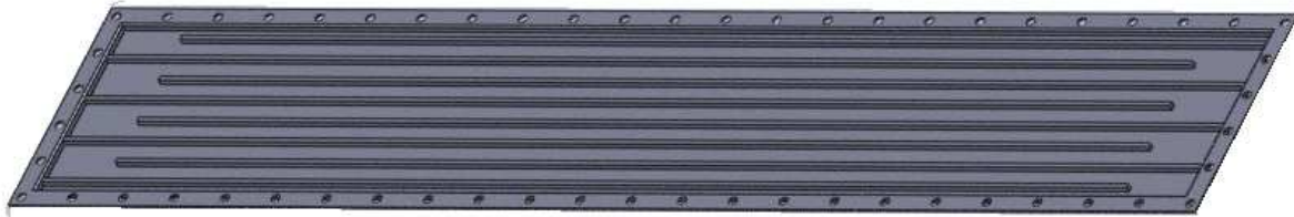
Figure 10 : L'échangeur capteur / cuve (boîte à eau)
