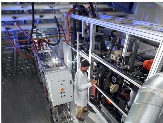
Figure 18 : Banc d'essai hydraulique et banc d'ensoleillement artificiel
