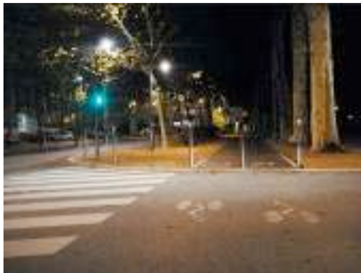
Sources de lumière dans les arbres et déficit d'éclairage sur la piste cyclable
