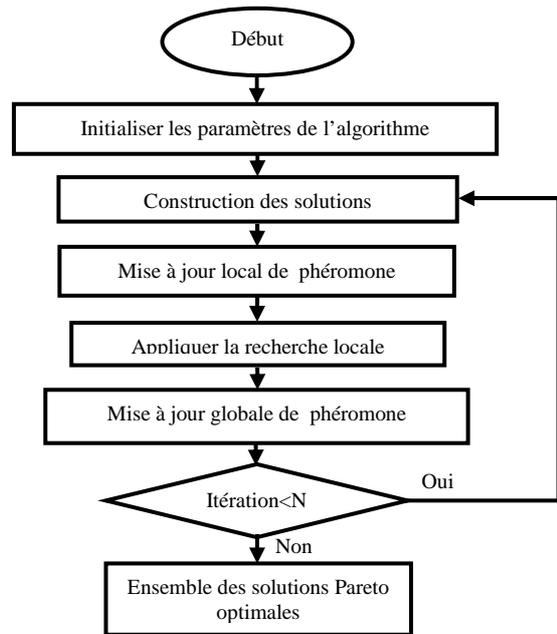
Figure 1 : Algorithme P-ACO
