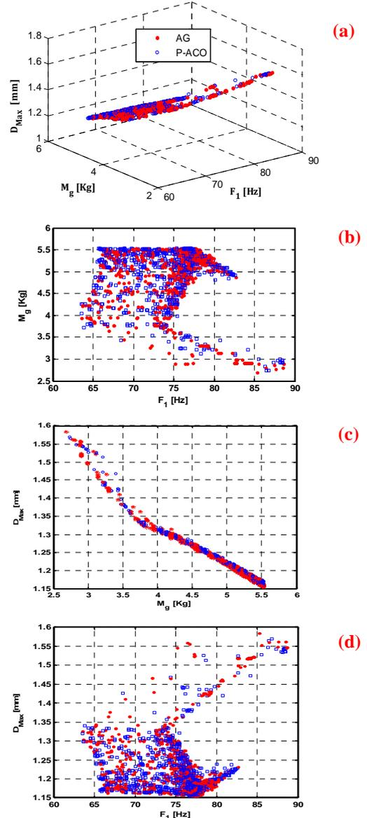
**Figure 4** : Ensembles des solutions Pareto optimales issus de l'application d'un AG (NSGA-1) et un P-ACO: (a) : dans l'espace ( $F_1, D_{Max}, M_g$ ), (b) : dans le plan ( $F_1, M_g$ ), (c) : dans le plan ( $M_g, D_{Max}$ ), (d) : dans le plan ( $F_1, D_{Max}$ ).
