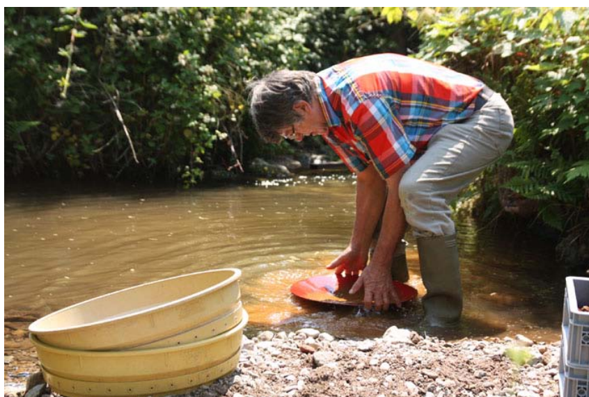
Figure 44 : Traitement des sols prélevés à la batée
