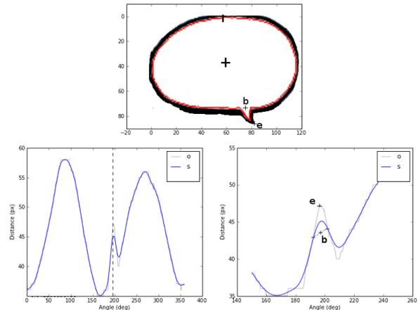
FIGURE 5 – Exemple d'une bulle (en haut) et de son contour original  $o$ , du contour lissé  $s$  (à gauche) et de la détection des points  $e$  et  $b$  de la queue (à droite). La mesure du contour  $o$  correspond, sur la bulle, à la distance entre son barycentre (croix noire) et le contour de la bulle sur  $360^\circ$  à partir du repère noir (en haut de la bulle) et dans le sens antihoraire.
