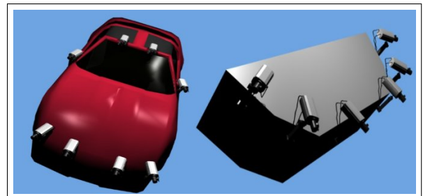
FIGURE 1 – Une configuration multi-caméras modélisée pour un prototype de laboratoire (à droite) et embarquée sur un véhicule (à gauche)
