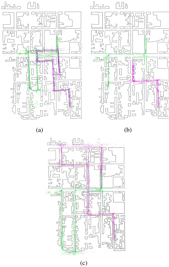
FIGURE 3 – Localisation en milieu urbain avec un SLAM contraint : (a) SLAM classique, (b) SLAM contraint au modèle des bâtiments SIG, (c) SLAM contraint au modèle SIG et MET.
