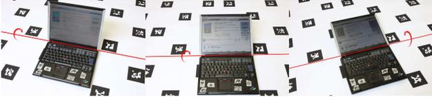
FIGURE 2 – Exemple de calcul de l'axe de rotation  $\mathbf{a}$  de l'écran d'un ordinateur portable. Voir Sec. 9.1.
