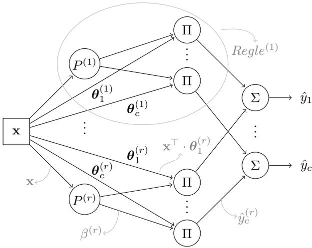
FIGURE 1 – Système d'inférence floue (SIF) du premier ordre sous la forme d'un réseau de neurones à fonctions de bases radiales (RBF)
