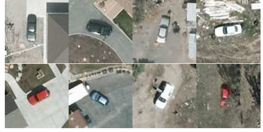
FIGURE 4 – Régions de 100 \times 100 pixels centrées sur des voitures (base VeDAI). La taille, les reflets spéculaires, les ombres et occlusions rendent la tâche de détection difficile.
