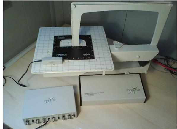
Fig 9 : Support d'expérience **ABS** (Ampère – Biot – Savart). Son plateau amovible permet d'étudier la spire carrée, et de positionner des contours de repérage de l'abs-cisse curviligne le long de contours d'intégration lors de la réalisation de la circulation de  $\vec{B}$ .
