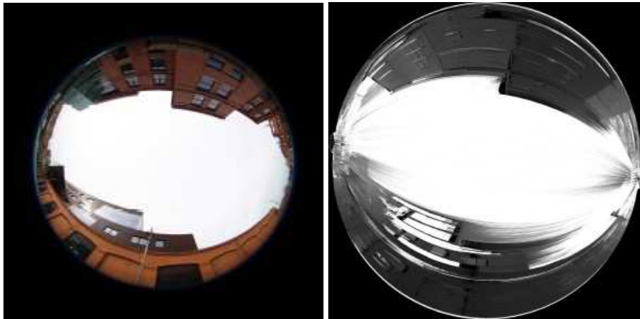
Figure 6 : Résultats de la mise en correspondance sur des images réelles : (gauche) Image brute (droite) carte de distances
