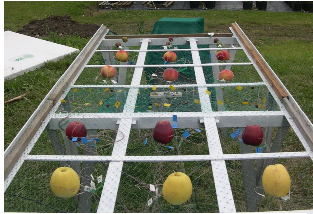
Figure 1 : Dispositif de mesure de la température de différents fruits
