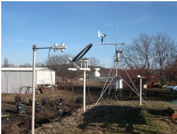
Figure 3 : Dispositif de mesures du microclimat : bilanmètre CNR1 (Kipp & Zonen) au premier plan, Pyranomètre avec bande équatoriale au deuxième plan puis mât météo.
