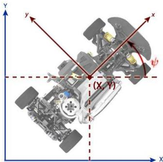
Figura 5. Representación de la posición del vehículo.
