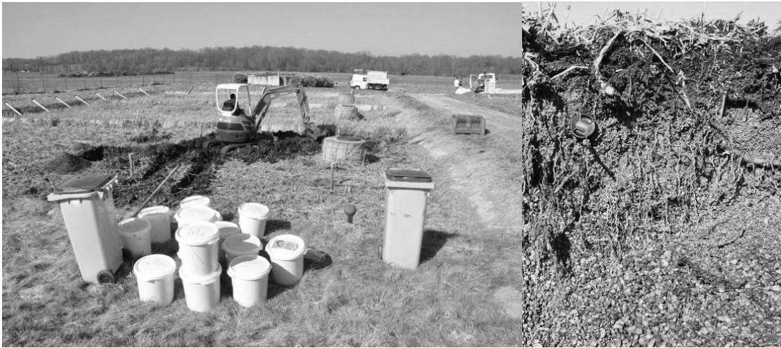
Figure 3 : Prélèvement des boues sur la station d'épuration de Vercia (Jura) en période hivernale. Vue générale (à gauche) et vue en coupe (à droite) d'une tranchée de prélèvement montrant la couche de boues en surface (couleur noire).
