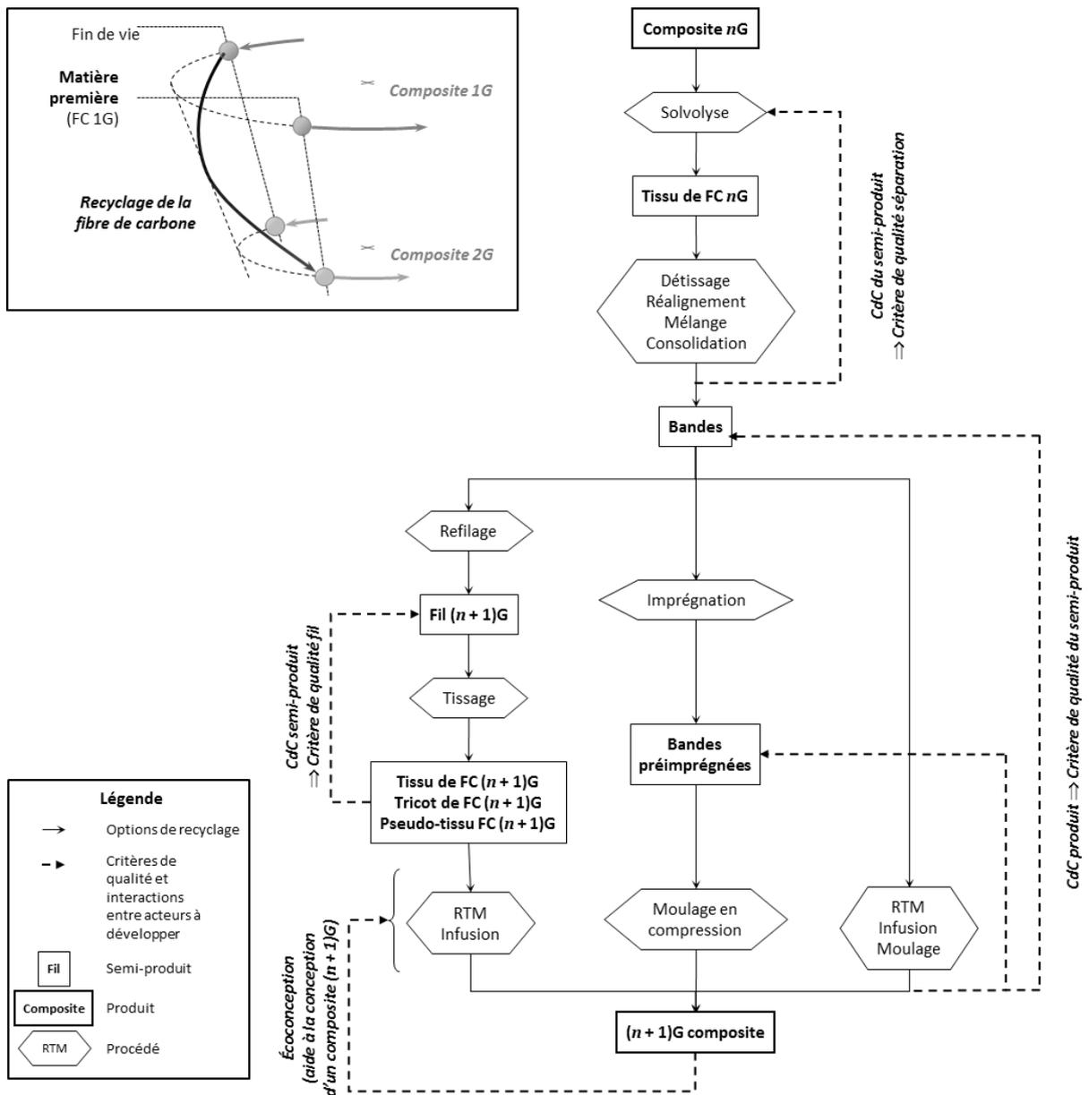
**Figure 3.** Ligne de recyclage d'un composite à fibre de carbone et matrice thermosettable (détail de la Figure 2) et arborescence associée. Cette dernière montre d'une part les interactions entre acteurs et d'autre part, les critères de qualité associés à développer.
