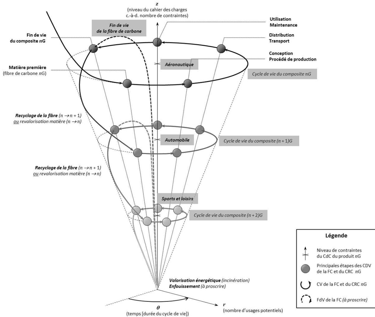
**Figure 2.** Représentation en coordonnées cylindriques du cycle de vie de la fibre de carbone. Intégration des (r)FC dans les cycles de vie successifs de plusieurs produits, en fonction du niveau de contraintes  $z$  du cahier des charges. Le rayon  $r$  dépend du nombre d'utilisations potentielles de la (r)FC.  $\theta$  représente le temps (modulo la durée du  $n$ ème cycle).
