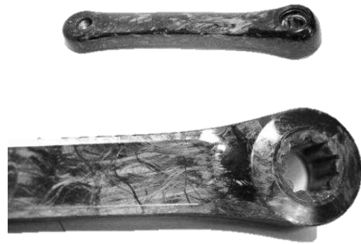
Figure 7. Manivelle de pédalier Natec. Caractéristiques attendues : résistance spécifique et masse équivalente à celle de la manivelle du marché (approx. 185 g)
