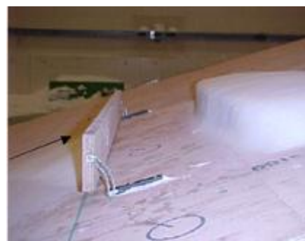
Figure 4. Des essais sur modèles réduits de transport de neige par le vent dans une soufflerie climatique (crédit : F. Naaim-Bouvet).
