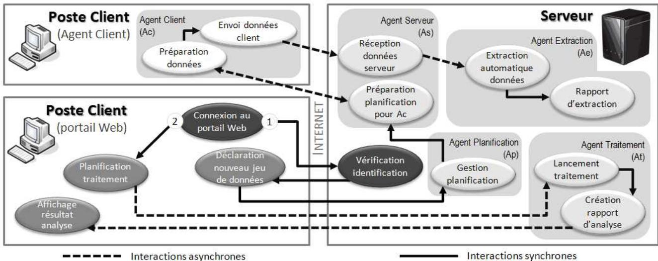
Figure 2 : workflow soutenu par la plateforme, au travers des interactions entre les agents logiciels
