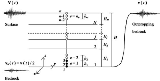
Figure 1. Discretisation spatiale d'un bassin sédimentaire horizontal multicouche secoué à la base par un séisme à trois composantes, enregistré sur rocher affleurant et divisé par deux.
