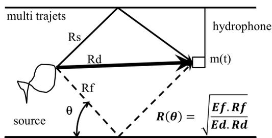
Figure 3. En première approximation, la propagation se fait le long de lignes droites et suivant trois trajets.  $E_d$  (resp.  $E_f$ ) est le niveau du trajet direct (resp. fond) intégré sur la bande de fréquences du signal ( $\mu Pa^2$ )
