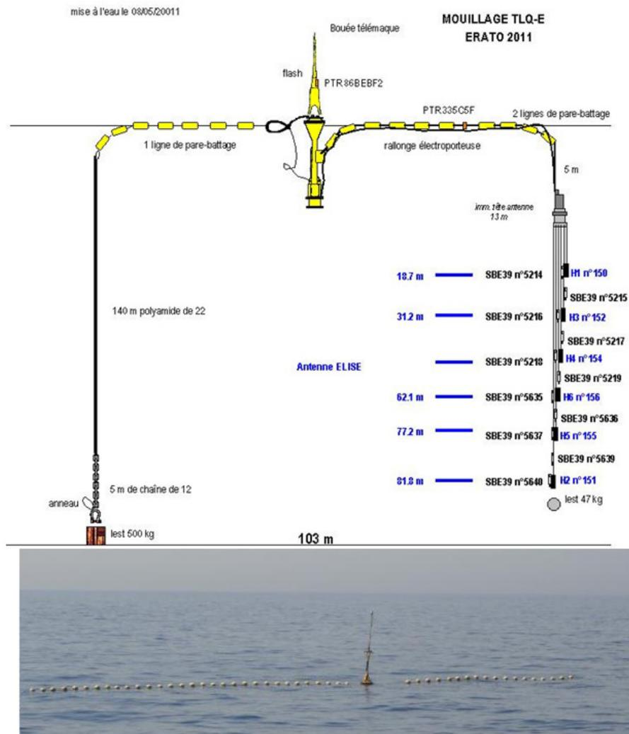
Figure 8. L'antenne d'hydrophones et la bouée TELEMAQUE
