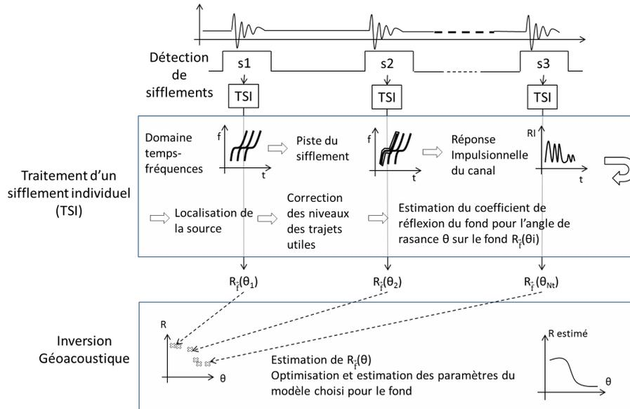
Figure 5. Architecture du schéma d'inversion avec une étape de traitement du signal d'une émission individuelle puis une étape d'inversion géoacoustique à partir de  $N_t$  émissions traitées
