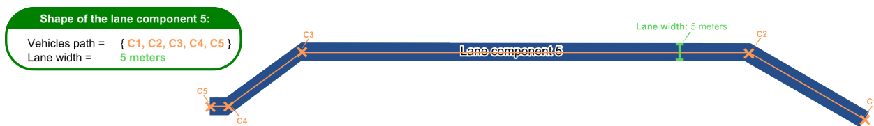
FIGURE 3.10 – Illustration de la notion de forme d’une voie dans le niveau ”Infrastructure”.
